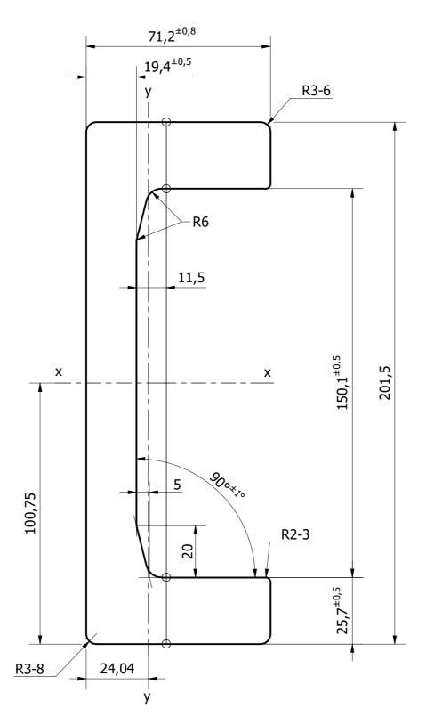
MODULI DI RESISTENZA MATERIALE MASSA LINEARE MOMENTI D'INERZIA 52.32 kg/m Wx 339,98 cm<sup>3</sup> EN 10025-2 S450J2 MOD. Jx 3425,2 cm<sup>4</sup> AREA Jy 269,63 cm<sup>4</sup> 66,57 cm<sup>2</sup> Wy 57,169 cm<sup>3</sup>
